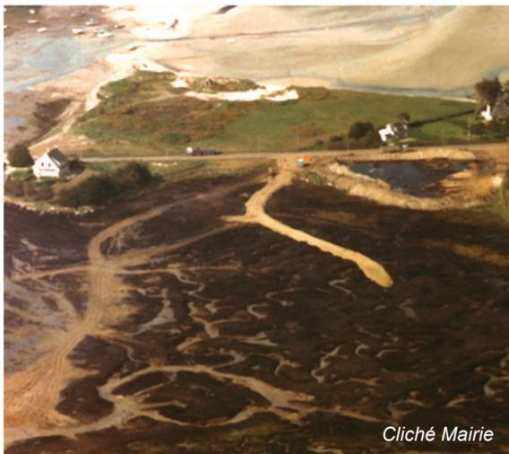
La grande superficie du marais de Notenno nécessite la construction en avril de 400 m de route empierrée afin de permettre la pénétration et la circulation des camions au cœur du marais. À partir des zones de stationnement, les camions pompent le pétrole que les soldats concentrent dans les chenaux à l'aide de raclettes. Les poubelles chargées de pétrole et de déchets mazoutés sont chargées dans les remorques.
